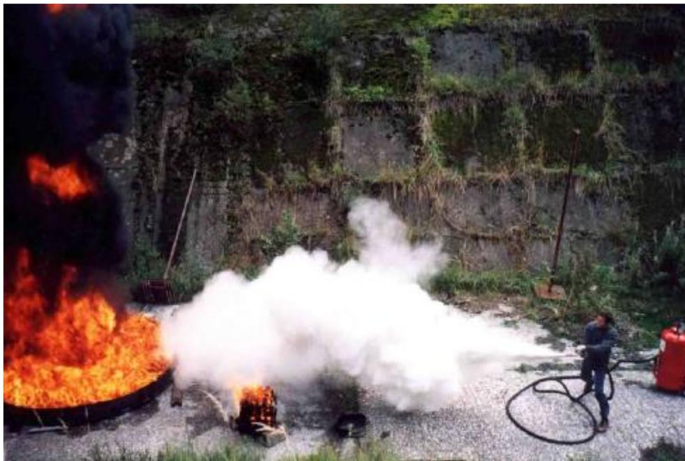
**Рис. 3.** Работа огнетушителя ОП-80 (г)
