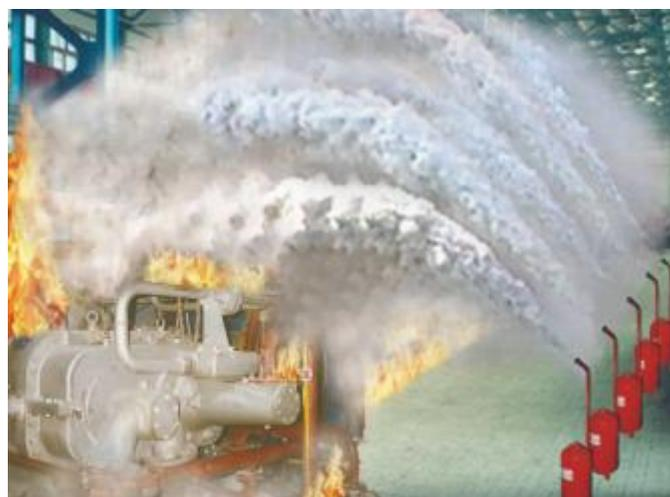
**Рис. 4.** Работа КУП «аэрозоль - порошок» на производственном объекте
